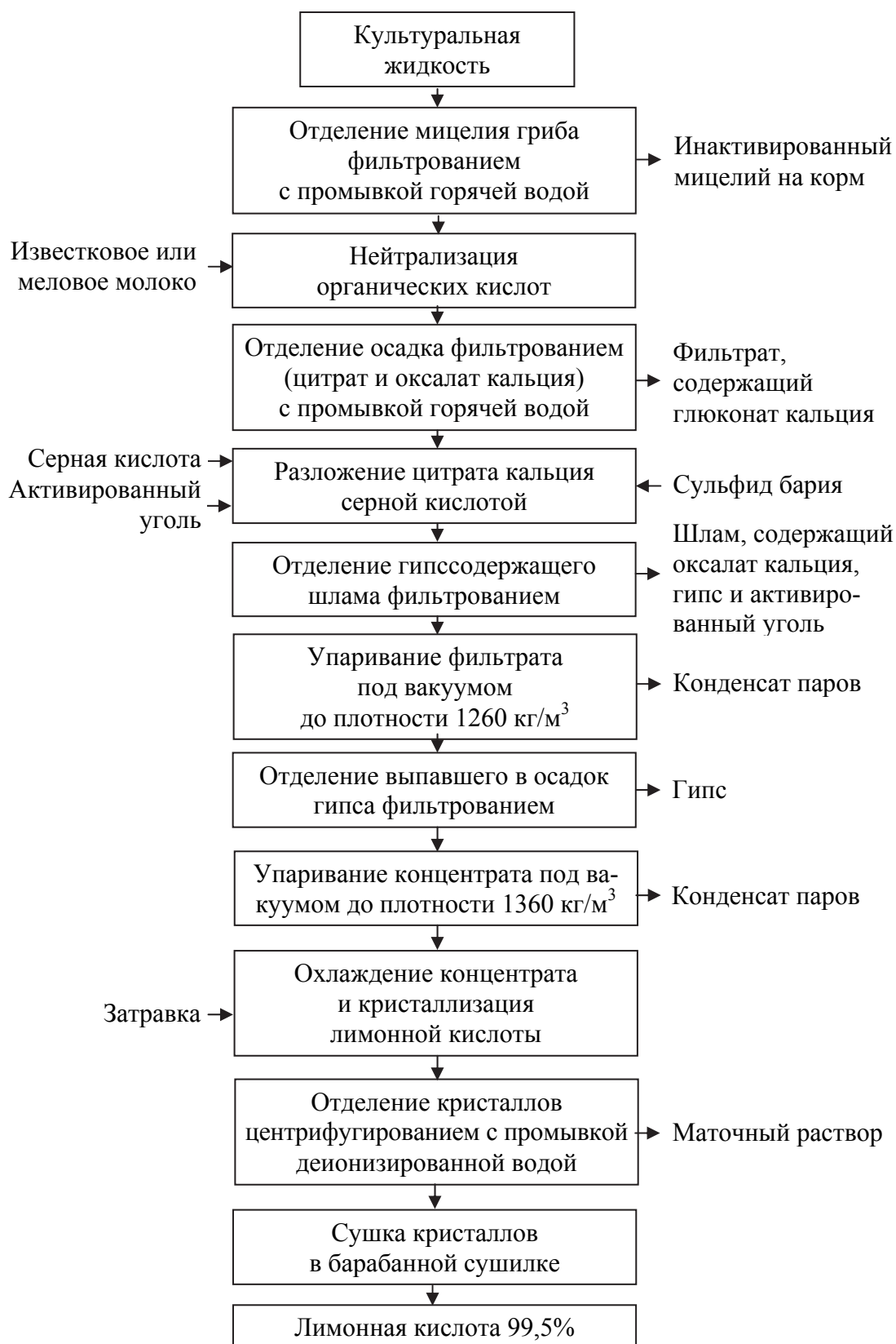
Рис. 13.2. Схема выделения лимонной кислоты из культуральной жидкости
